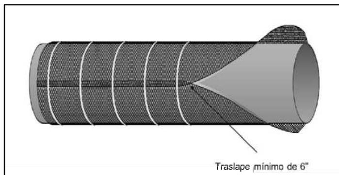
Para ductos de gran diámetro se obtiene mejores tiempos de ejecución con dos aplicadores que se apoyan con el traslape de la cinta, ubicando cada uno de ellos a cada lado del ducto.
