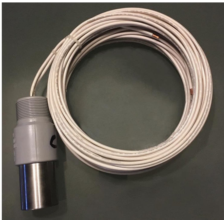
Cupón de corrosión exterior para monitoreo de protección catódica de plataformas (100 cm 2 ) con cable THHN-THWN calibre 10 AWG.
