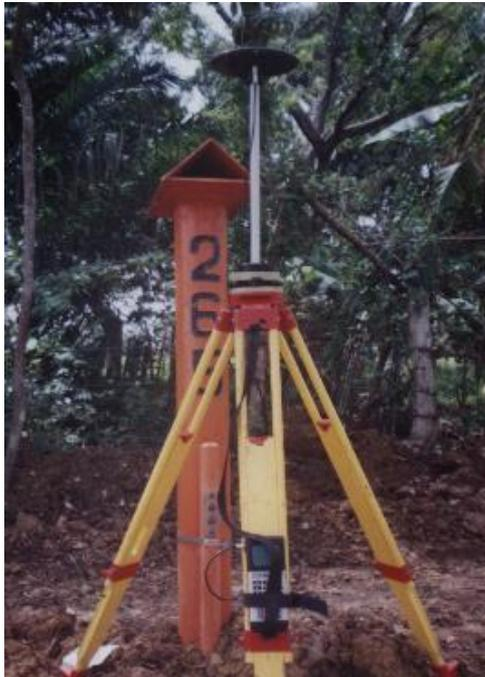
El GPS permite darle posición a cada valor de resistividad que se toma con el equipo de conductividad.
