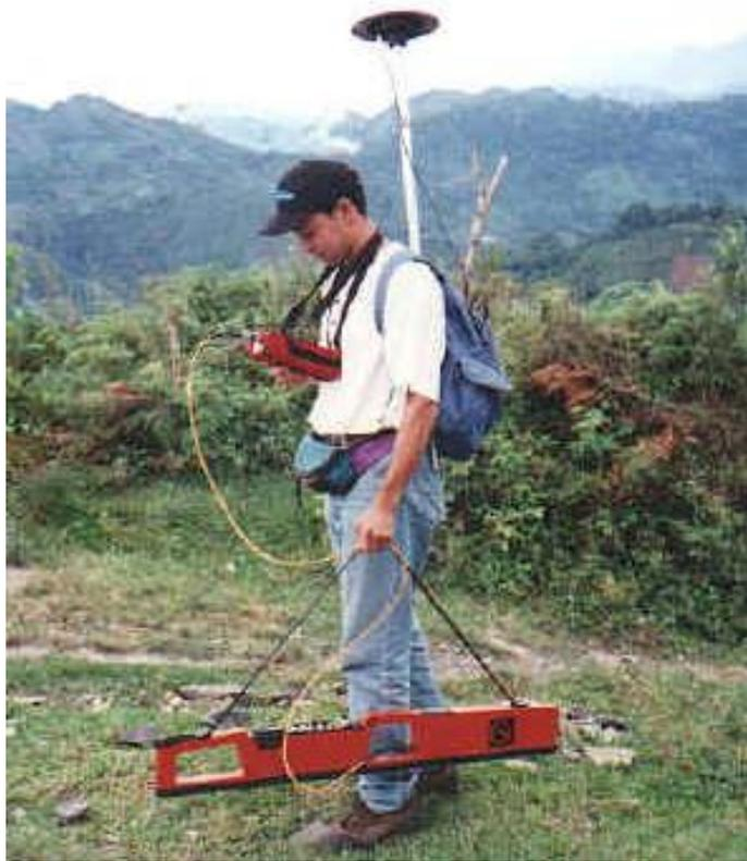
Levantamiento del perfil de resistividad en campo
